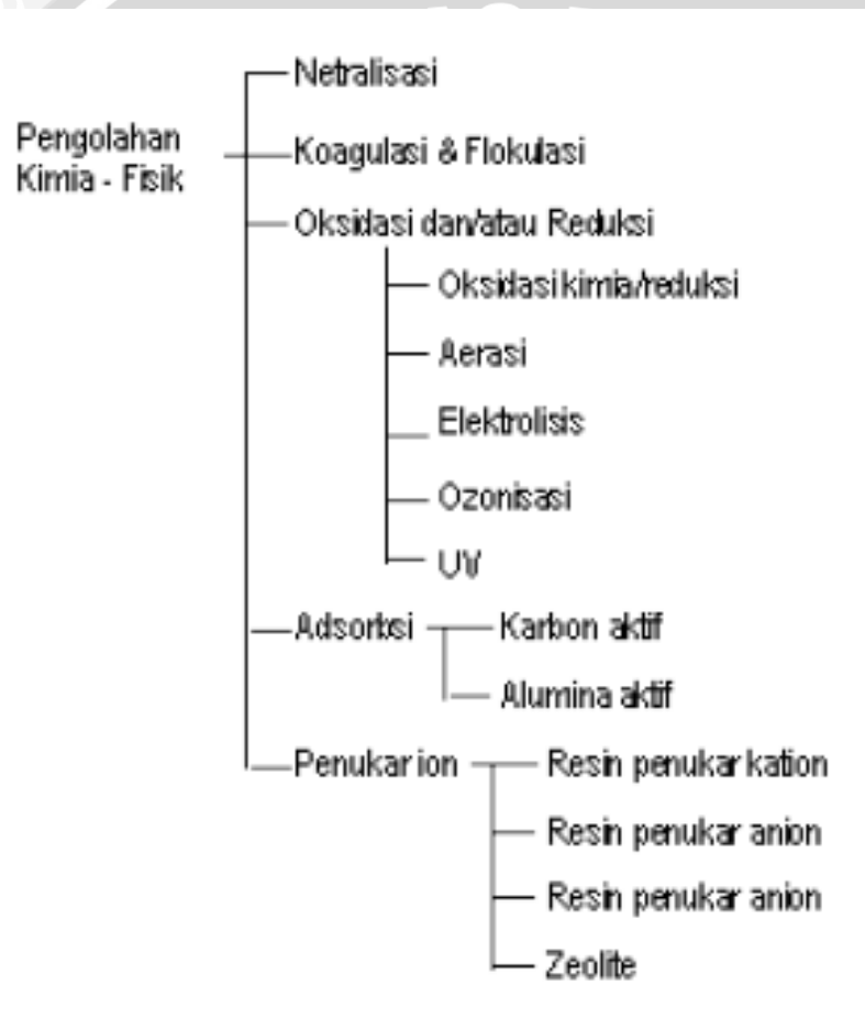
Gambar 2.12b Skema Pengolahan Kimia
