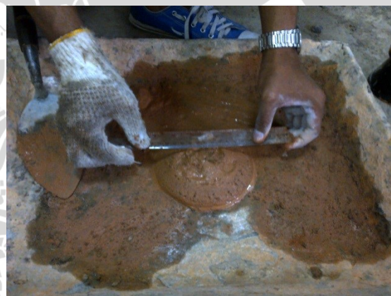
(Pengujian kelecakan Mortar)
