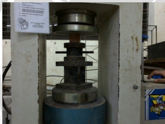
(Pengujian Kuat Tekan)
