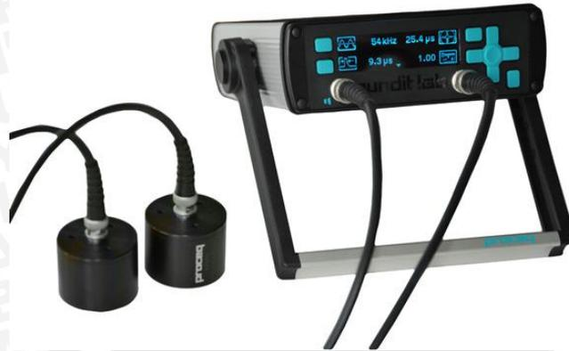
**Gambar 2.2** Alat Uji UPV : Pundit Lab (+)
