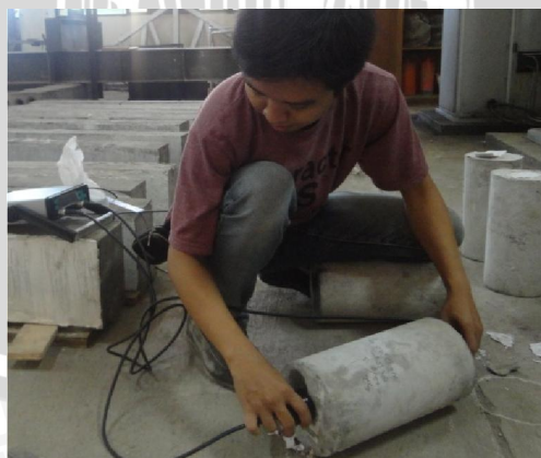
Gambar 4.6 Pengujian Kecepatan Gelombang Pada Silinder dengan UPV (Sumber : dokumentasi penelitian)
