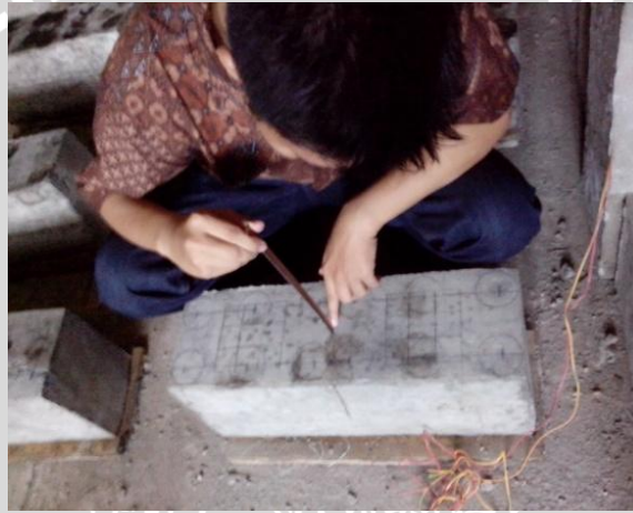
Gambar 4.8 Pengukuran Kedalaman Retak yang Sebenarnya (Sumber : dokumentasi penelitian)
