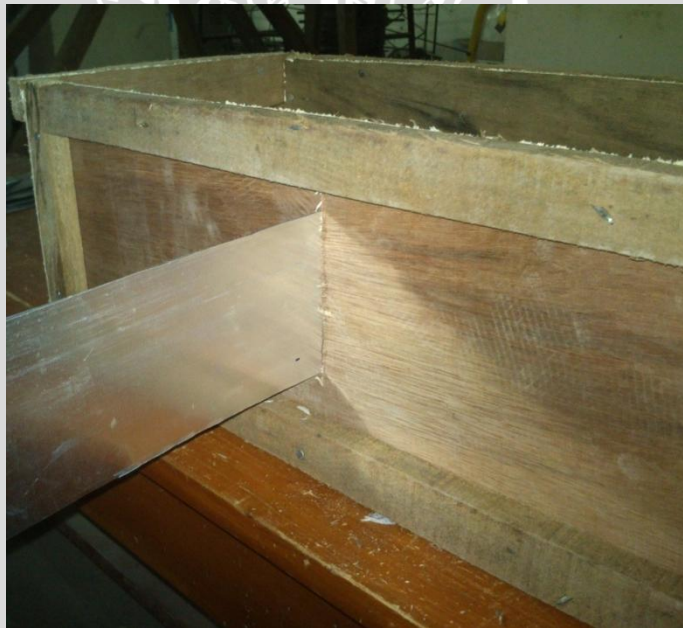
Gambar 4.3 Retak Buatan (Sumber : dokumentasi penelitian)
