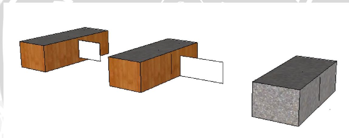
**Gambar 3. 1** Pembuatan Retak Buatan
