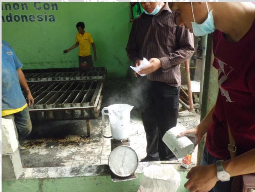
Gambar. Proses Penimbangan Piropilit sebelum dicampurkan pada adonan
