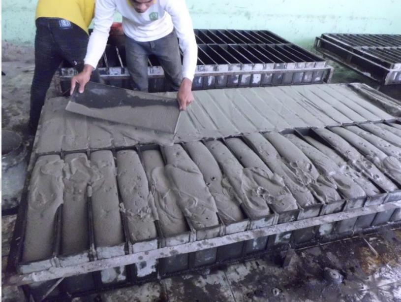
Gambar. Pencetakan Benda Uji
