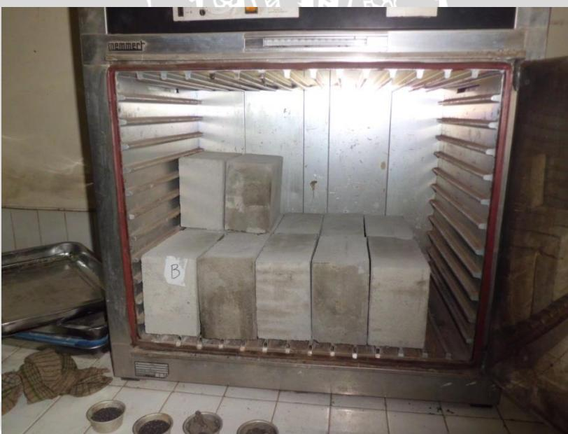
Gambar. Proses Pengeringan Benda Uji dengan Cara di Oven
