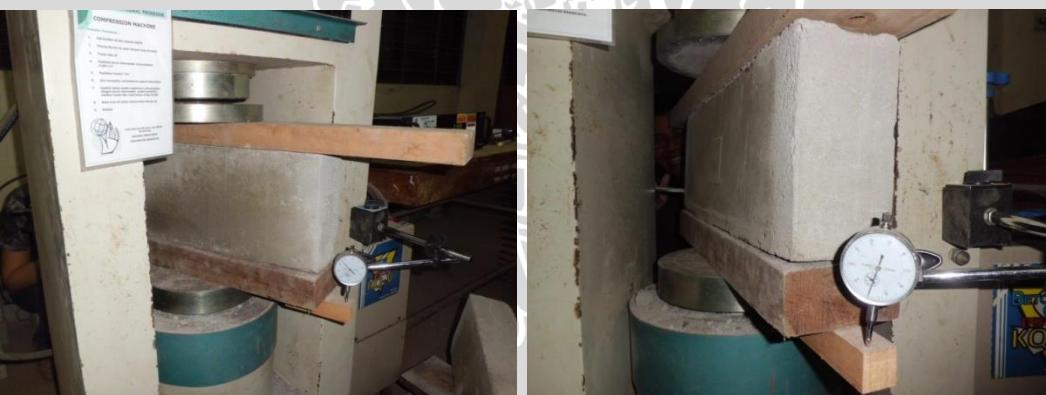
Gambar. Pengujian Kuat Tekan dan Pencatatan Dial
