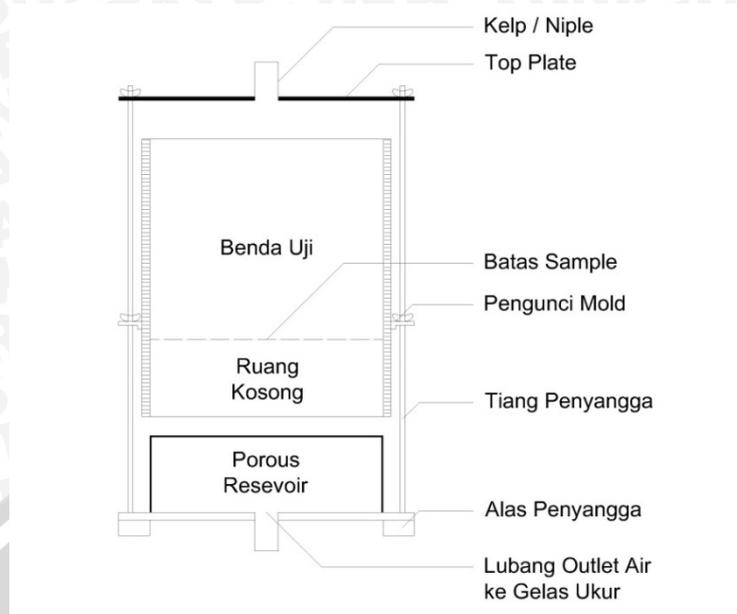
**Gambar 3.4** Potongan melintang *mold* modifikasi *constant head* sekaligus CBR
