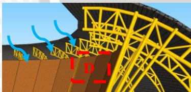
Konstruksi dinding menggunakan bambu bilah yang sudah diawetkan menggunakan cat ter
