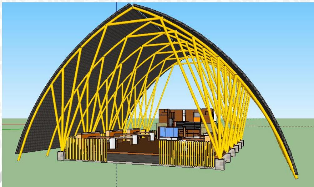
**Gambar 4.120** : Struktur bambu membentuk ruang Cafe
