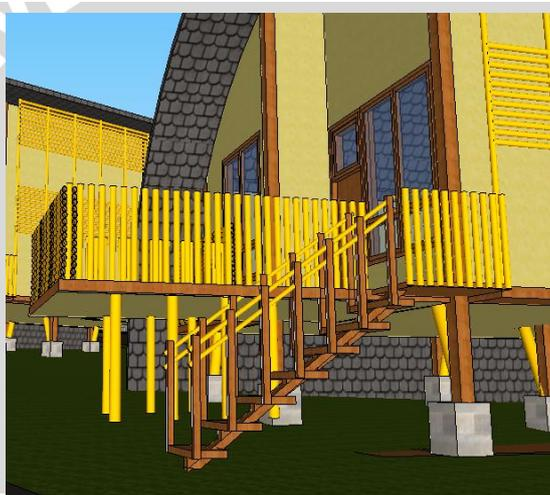
**Gambar 4.108 :** Konstruksi Tangga kayu dan bambu
