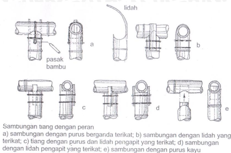
Gambar 2.38 : Sambungan tiang dan kuda penopang Sumber: Ilmu konstruksi bambu seri 7, Ir.heinz freak
