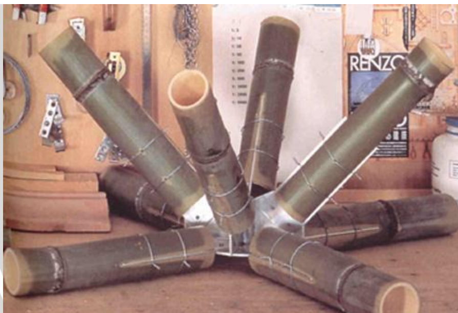
Gambar 2.48: sambungan bambu dengan titik buhul pipa baja Sumber gambar : Publikasi.pdf / Ir. Suwarsono, MT-Universitas Muhammadiyah Malang Maret 2009
