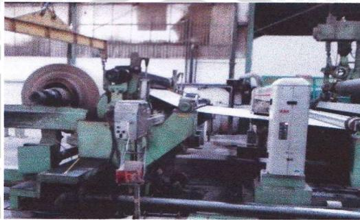
Gambar 4.27 Mesin *pope reel* dan mesin *scanner*
