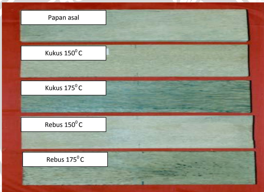
Gambar 2.1. Hasil pemampatan kayu kelapa
