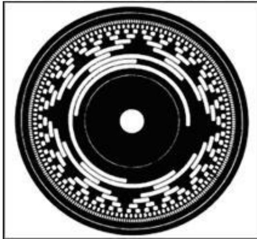
Gambar 8. Contoh susunan pola 16 cincin konsentris pada absolut encoder
