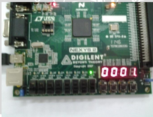
Gambar 5.3 Pengujian input/output pada modul FPGA
