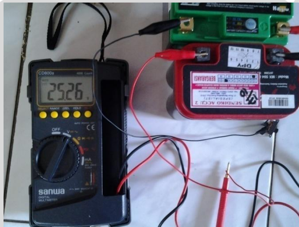
Gambar 5.1 Pengujian tegangan masukan dan keluaran pada rangkaian catu daya 25V dengan menggunakan multimeter
