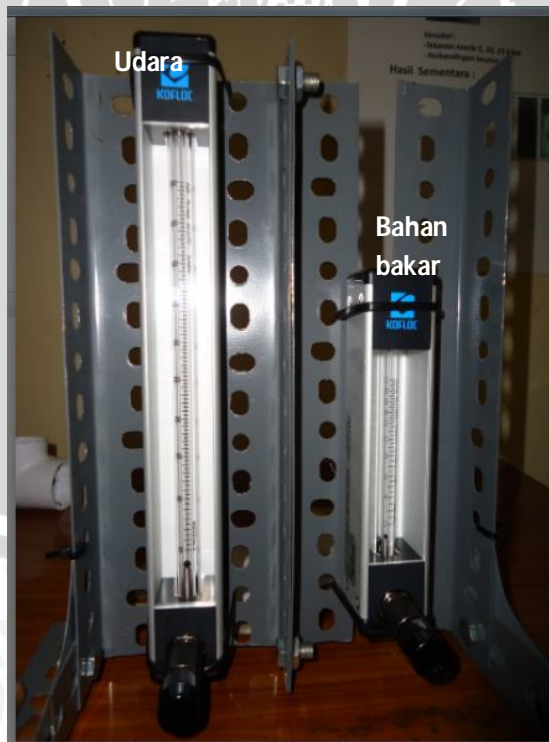
Gambar 3.6 Flow meter udara dan bahan bakar
