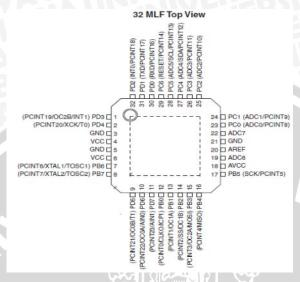
Gambar 2.9 Konfigurasi Pin Atmega 168
