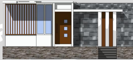
Gambar 4.76 : Bagian dinding yang dilapisi dengan batu alam
