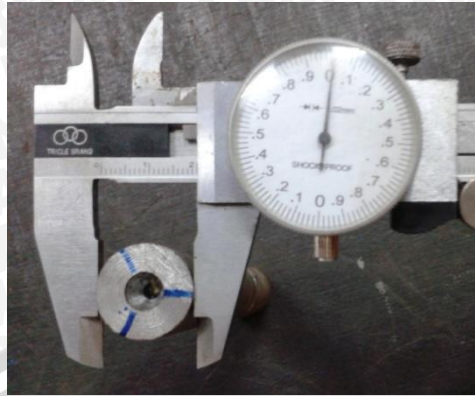
Gambar 3.8 Cara Pengukuran penyimpangan kebulatan spesimen
