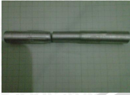
7. Spesimen Setelah Uji Puntir
