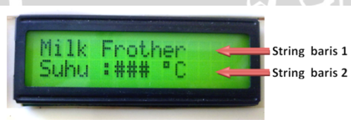
Gambar 14 Hasil Pengujian LCD 2x16 Karakter
