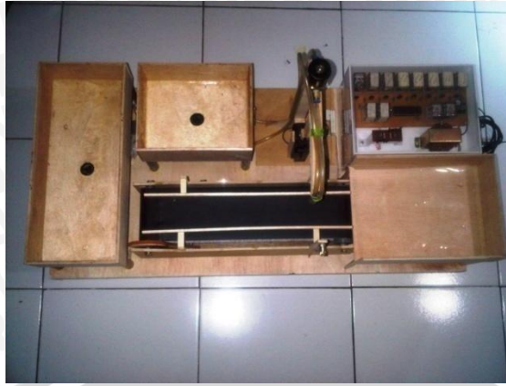
Gambar 5.2. Realisasi Miniatur Tangki dan Konveyor
