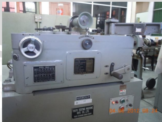
Gambar 3.11 : Alat uji keausan Ogoshi
