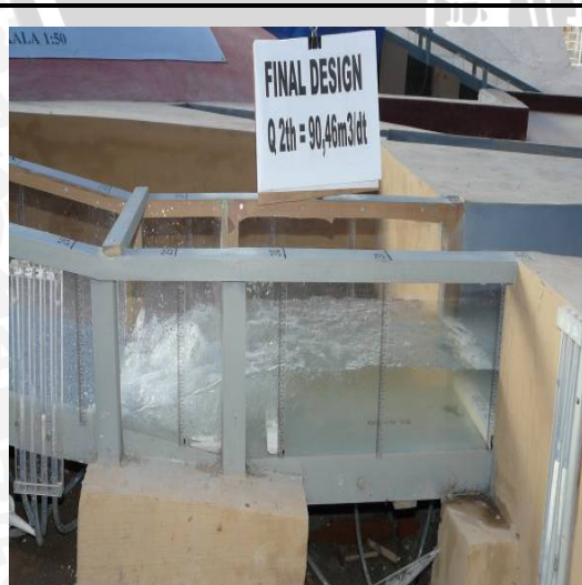
Foto.41. Kondisi aliran pada peredam energi Q 2th
