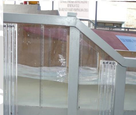
Foto 14. Kondisi aliran pada saluran transisi
