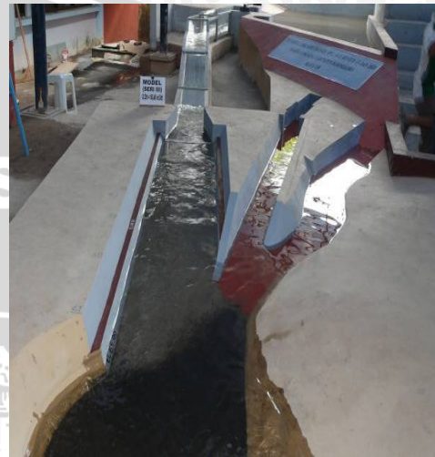
Foto.34. Kondisi aliran pada saluran pengarah hilir seri III Q 2th
