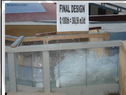
Foto.45. Kondisi aliran pada peredam energi Q 1000th
