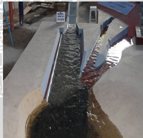
Foto.36. Kondisi aliran pada saluran pengarah hilir seri III Q 100th
