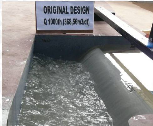
Foto 13. Kondisi aliran pada pelimpah
