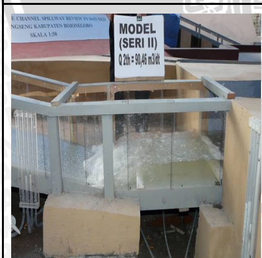
Foto.29. Kondisi aliran pada peredam energi seri II Q 2th
