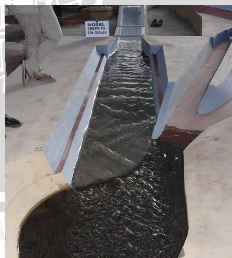
Foto.30. Kondisi aliran pada saluran pengarah hilir seri II Q 2th
