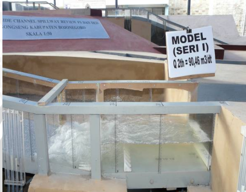
Foto.25. Kondisi aliran pada peredam energi seri 1 Q 2th
