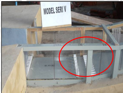
Gambar 4.39. Perubahan dimensi baffle block
