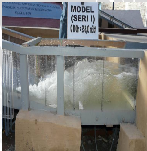
Foto.27. Kondisi aliran pada peredam energi seri 1 Q 100th
