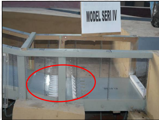
Gambar. 4.35. Perubahan dimensi pada chute block dan baffle block
