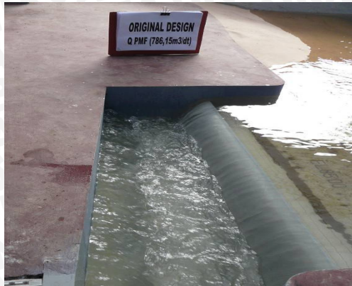
Foto 19. Kondisi aliran pada pelimpah
