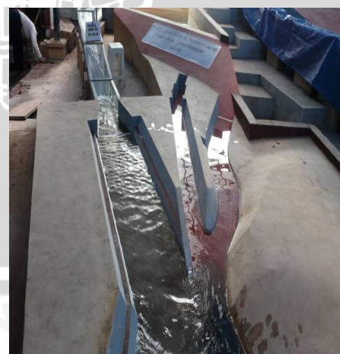
Foto.38. Kondisi aliran pada saluran pengarah hilir seri IV Q 2th
