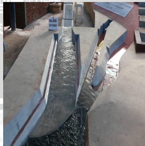
Foto.42. Kondisi aliran pada saluran pengarah hilir Q 2th
