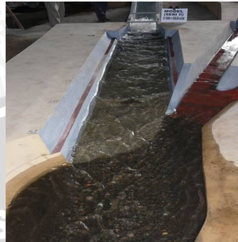
Foto.32. Kondisi aliran pada saluran pengarah hilir seri II Q 100th
