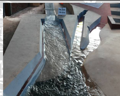
Foto.46. Kondisi aliran pada saluran pengarah hilir Q 1000th
