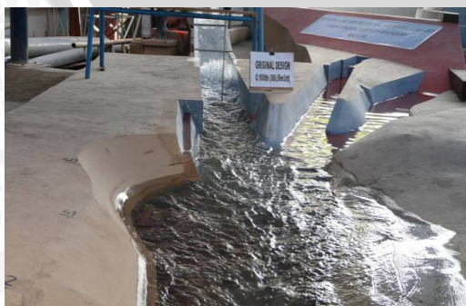
Foto 17. Kondisi aliran pada saluran pengarah hilir
