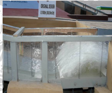
Foto 16. Kondisi aliran pada peredam energi
