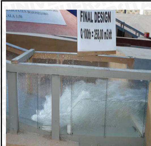
Foto.43. Kondisi aliran pada peredam energi Q 100th
