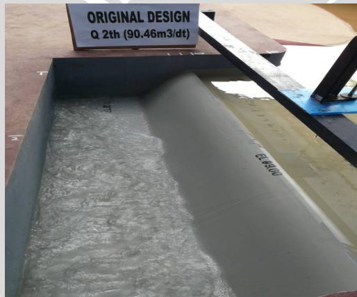
Foto 1. Kondisi aliran pada pelimpah dan side channel
