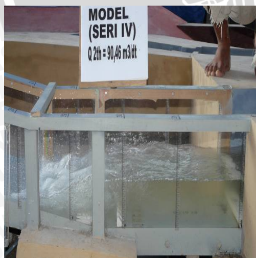
Foto.37. Kondisi aliran pada peredam energi seri IV Q 2th
