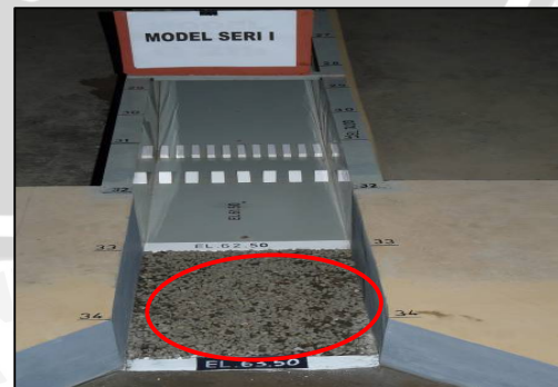
Gambar 4.30. Penambahan rip-rap pada terminal channel
