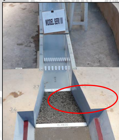
Gambar 4.32. Perubahan kemiringan terminal channel dari +63.50 menjadi +65.00
