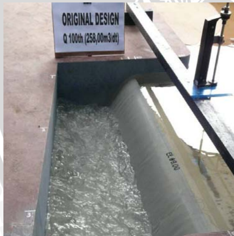
Foto 7. Kondisi aliran pada pelimpah
