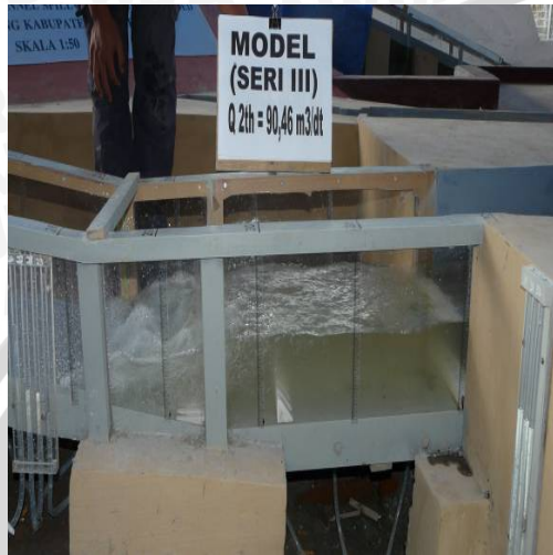
Foto.33. Kondisi aliran pada peredam energi seri III Q 2th
