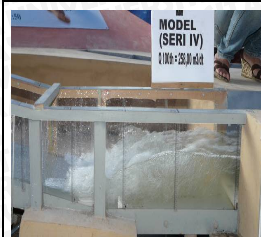
Foto.39. Kondisi aliran pada bagian peredam energi seri IV Q 100th
