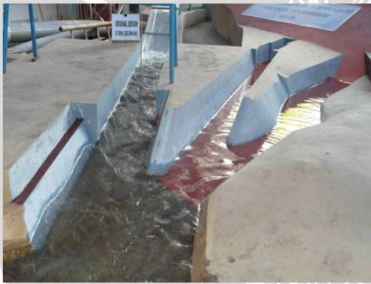
Foto 11. Kondisi aliran pada saluran pengarah hilir
