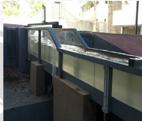
Foto 20. Kondisi aliran pada saluran transisi
