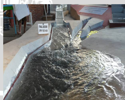
Foto.48. Kondisi aliran pada saluran pengarah hilir Q PMF
