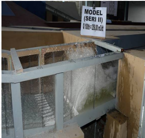
Foto.31. Kondisi aliran pada bagian peredam energi seri II Q 100th
