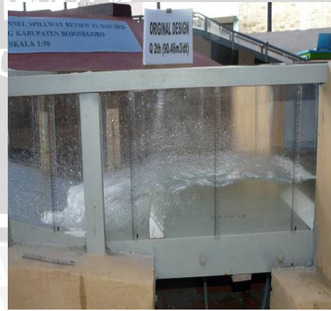
Foto 4. Kondisi aliran pada peredam energi
