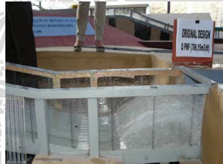
Foto 22. Kondisi aliran pada peredam energi
