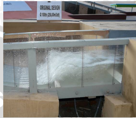
Foto 10. Kondisi aliran pada peredam energi
