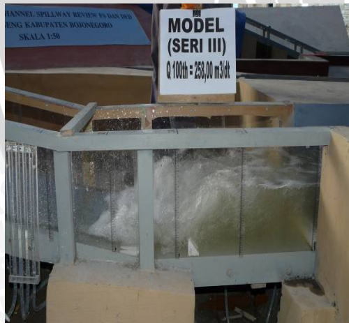
Foto.35. Kondisi aliran pada bagian peredam energi seri III Q 100th
