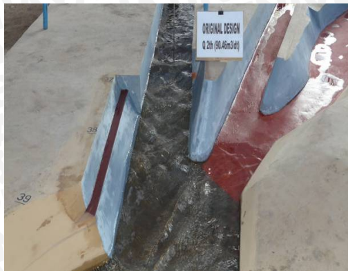
Foto 5. Kondisi aliran pada saluran pengarah hilir
