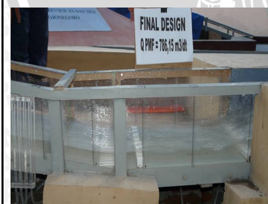
Foto.47. Kondisi aliran pada peredam energi Q PMF
