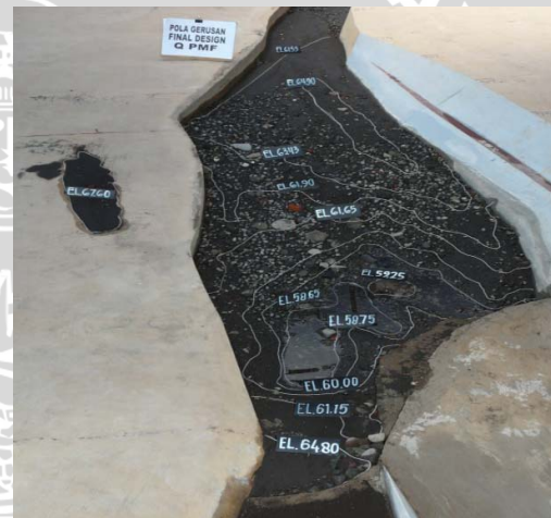
Foto 4. Pola gerusan Q_{PMF} tanpa perlindungan sungai
