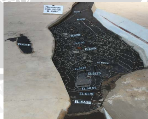
Foto 6. Pola gerusan Q_{PMF} dengan perlindungan sungai
