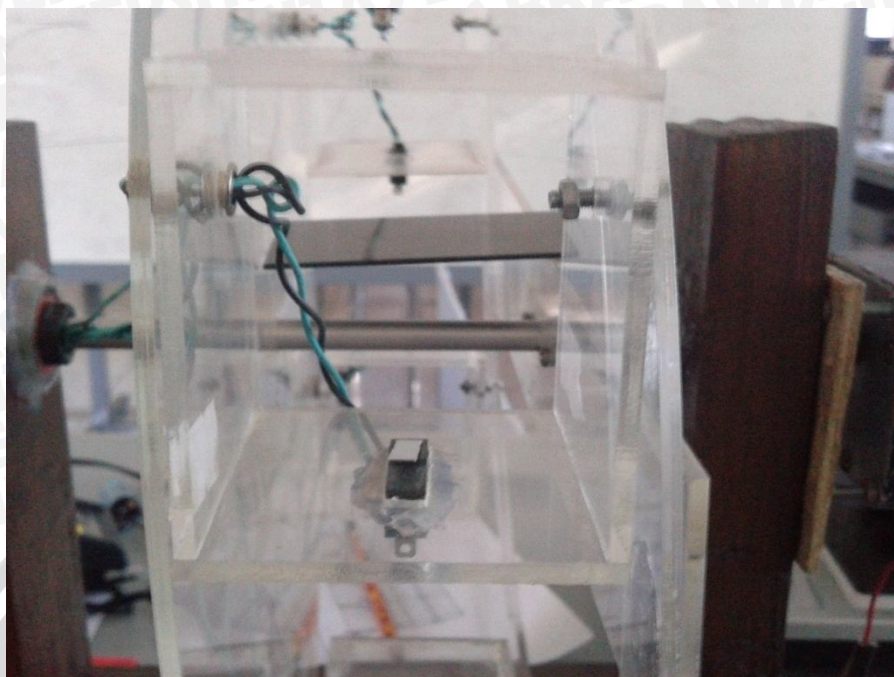
Gambar 7 Limit Switch Pada Garasi Model Rotary Parking
