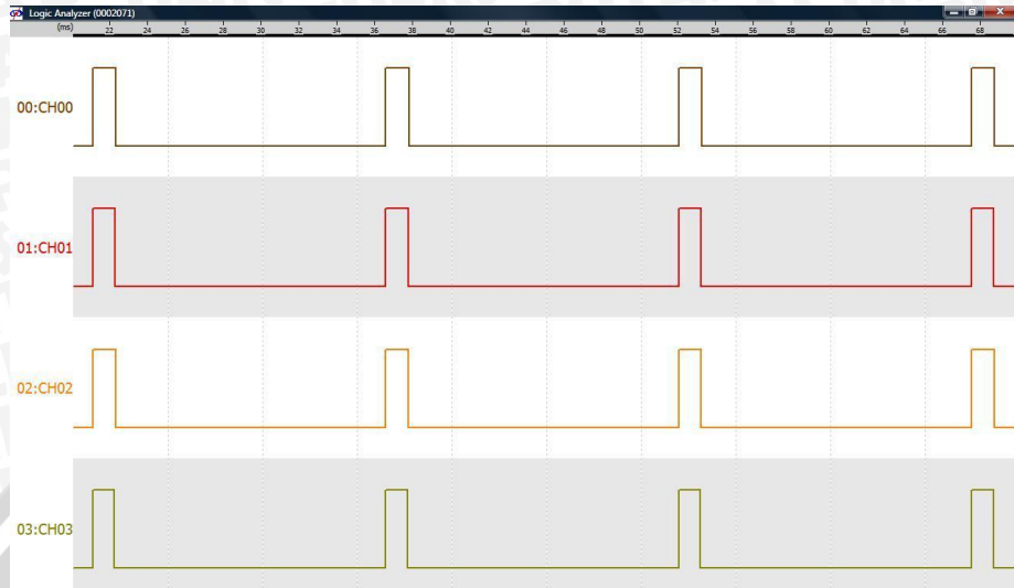
Gambar 5.6 Sinyal PWM Waktu Kondisi Diam
