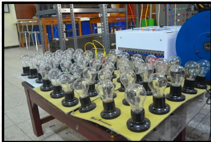
Lampu pijar sebagai beban komplemen pengujian
