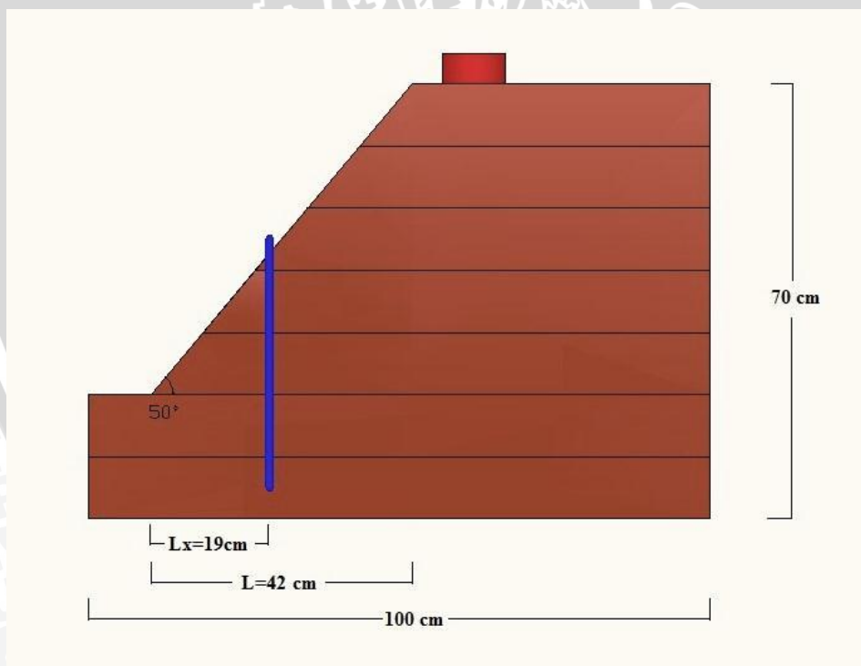
Gambar 4.15c Lereng dengan posisi pile tengah
