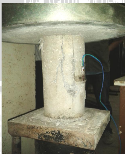
Gambar 4.6 Pengujian tekan dan elastisitas pile
