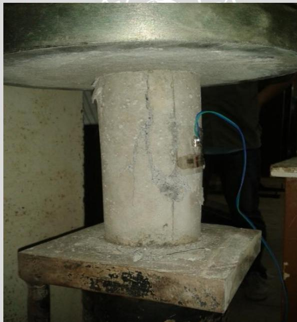
Gambar 4.8 Pengujian elastisitas bahan pada *pile*
