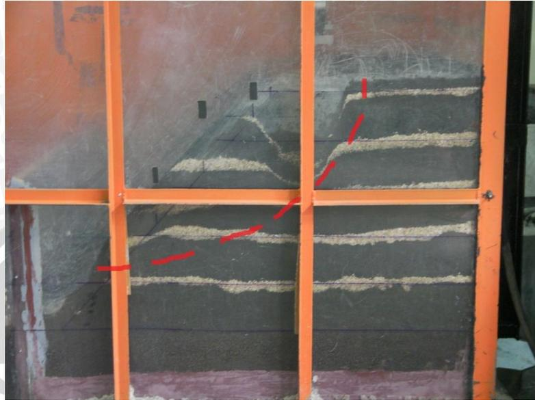
Gambar 4.11 Pola keruntuhan lereng yang terjadi di laboratorium
