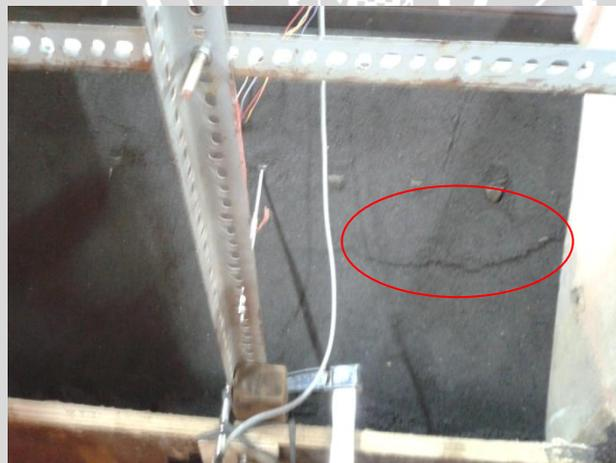
Gambar 4.13 Kondisi lereng dengan perkuatan *pile* setelah dibebani
