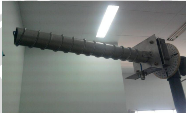
Gambar 4.7 Pemasangan antena helical
