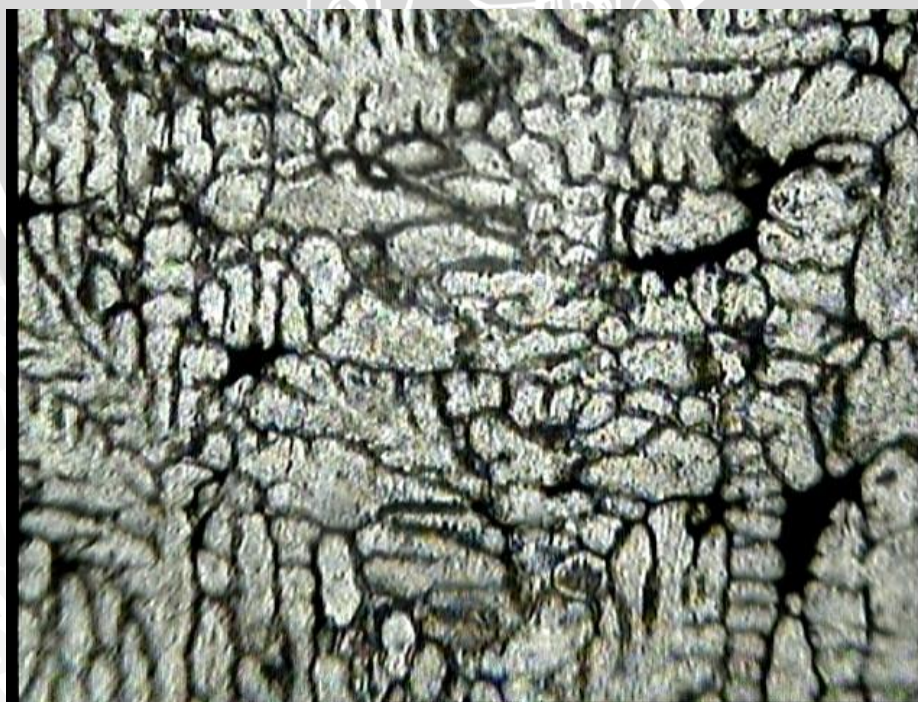
Gambar 4.1 Foto Mikro Dimensi Scrap Cu 5mm
