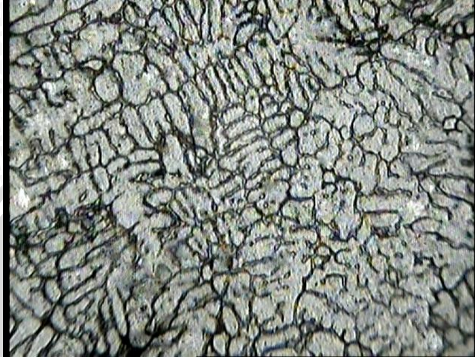
Gambar 4.5 Foto Mikro Dimensi Scrap Cu 15mm
