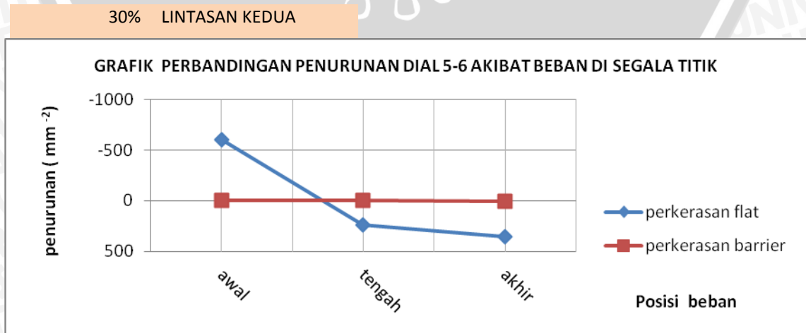
Gambar 4.19 Perbandingan penurunan tanah dial 5-6 akibat pola pembebanan (Lintasan II)
