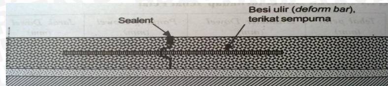
Gambar 2.6 Struktur sambungan konstruksi
