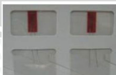
Gambar 2.16 Alat pengukur regangan elektrik ( strain gauges )
