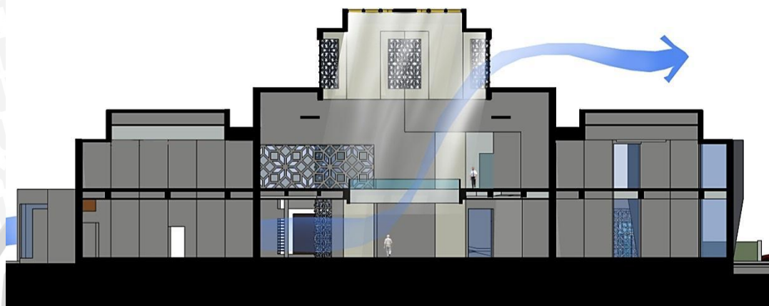
Gambar 4.83 simulasi cross ventilation dan masuknya sinar matahari ke dalam museum
