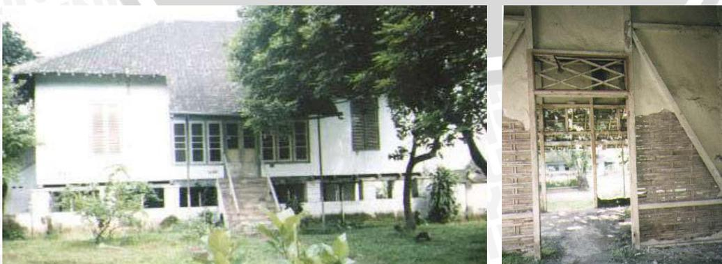
Gambar 2.7 penerapan bambu plester pada bangunan Belanda
