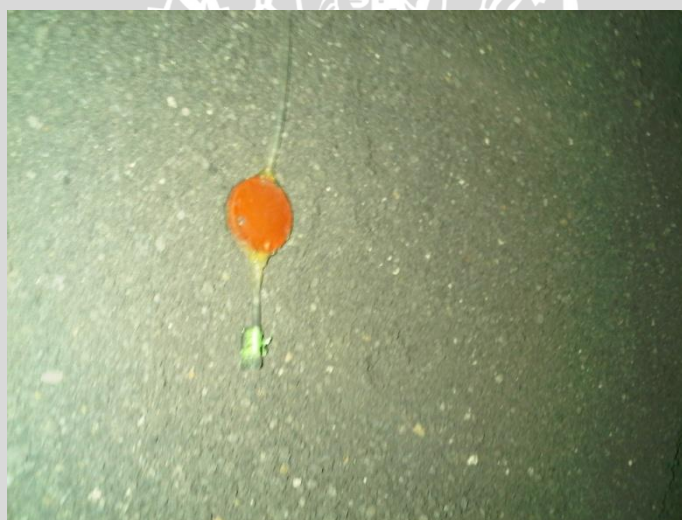
Perletakan alat pengukur tegangan dalam tanah
