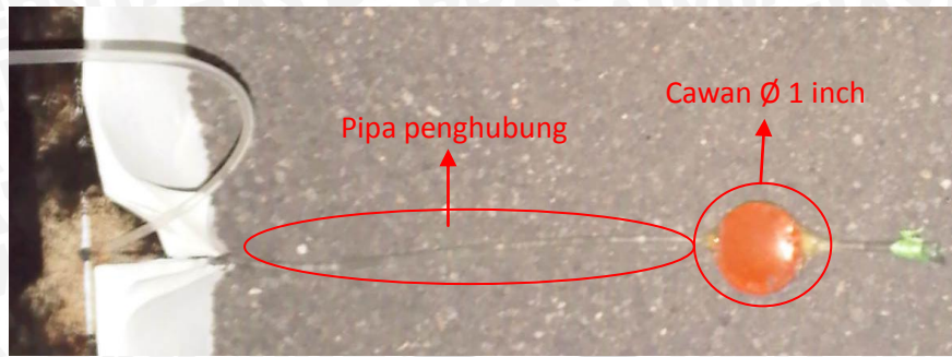
Gambar 2 cawan diameter 1 inch yang di atasnya tertutup membran karet dan pipa penghubung.
