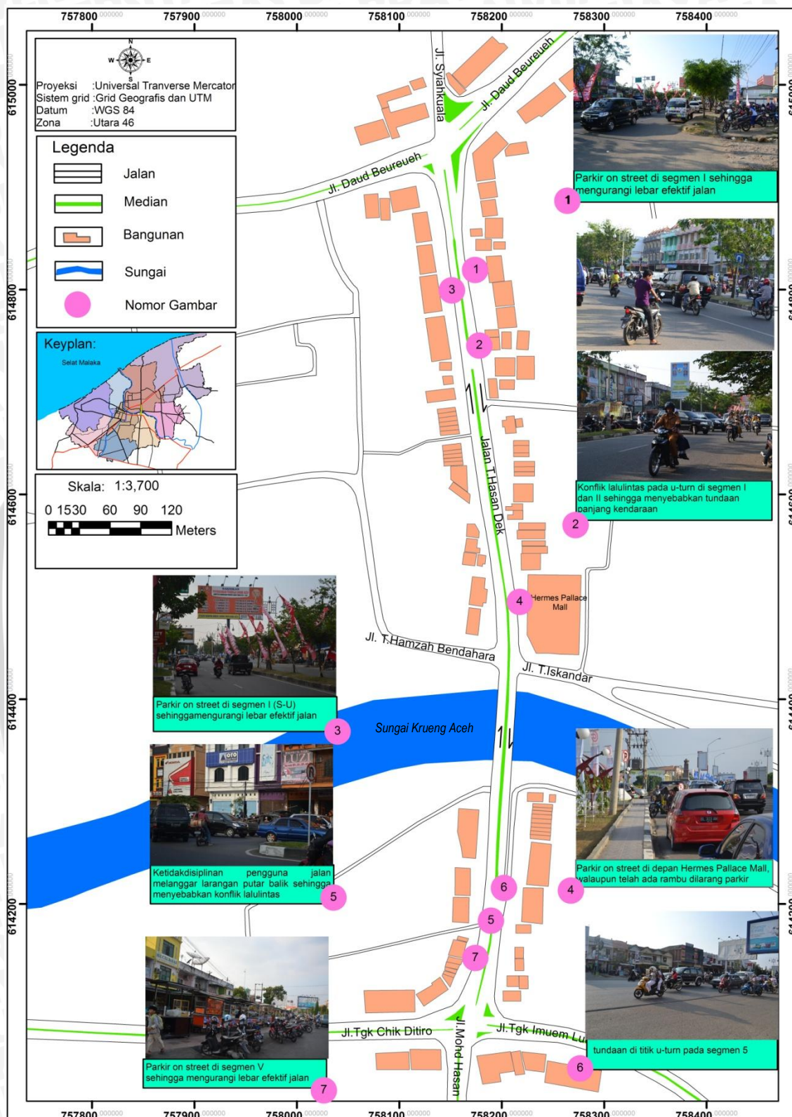
Gambar 4. 23 Foto Mapping Kondisi Lalulintas di Jalan T.Hasan Dek Sumber: Dinas Pekerjaan Umum Kota Banda Aceh, Google Earth 2004, Hasil Analisis 2012
