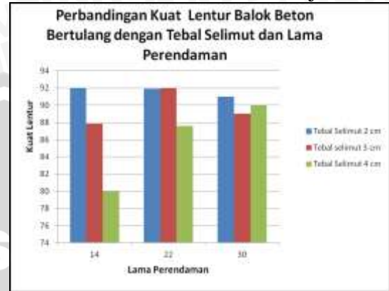
Gambar 3 Diagram Batang Perbandingan Kuat lentur Balok dengan Tebal Selimut dan Lama Perendaman Benda Uji A
