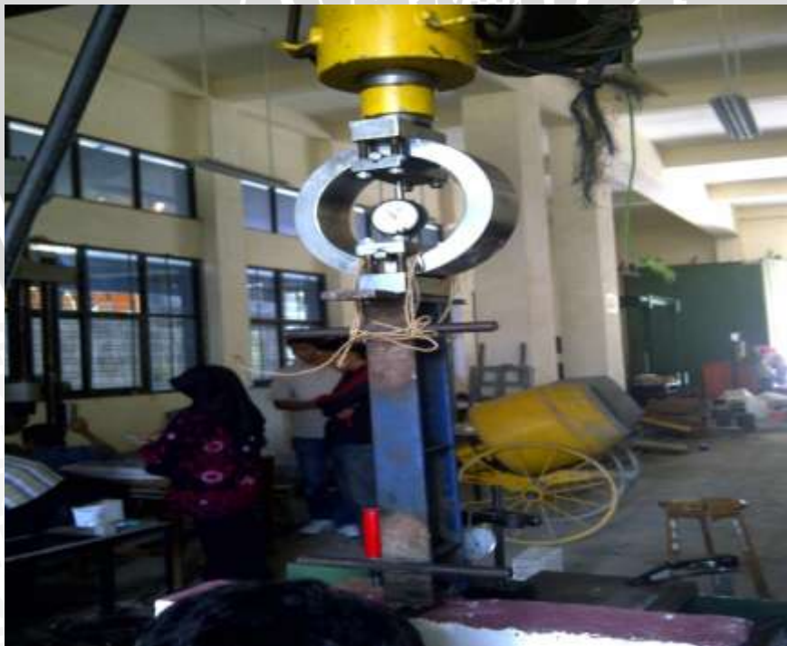
Gambar 4.3. Proven Ring untuk Pembebanan Balok
