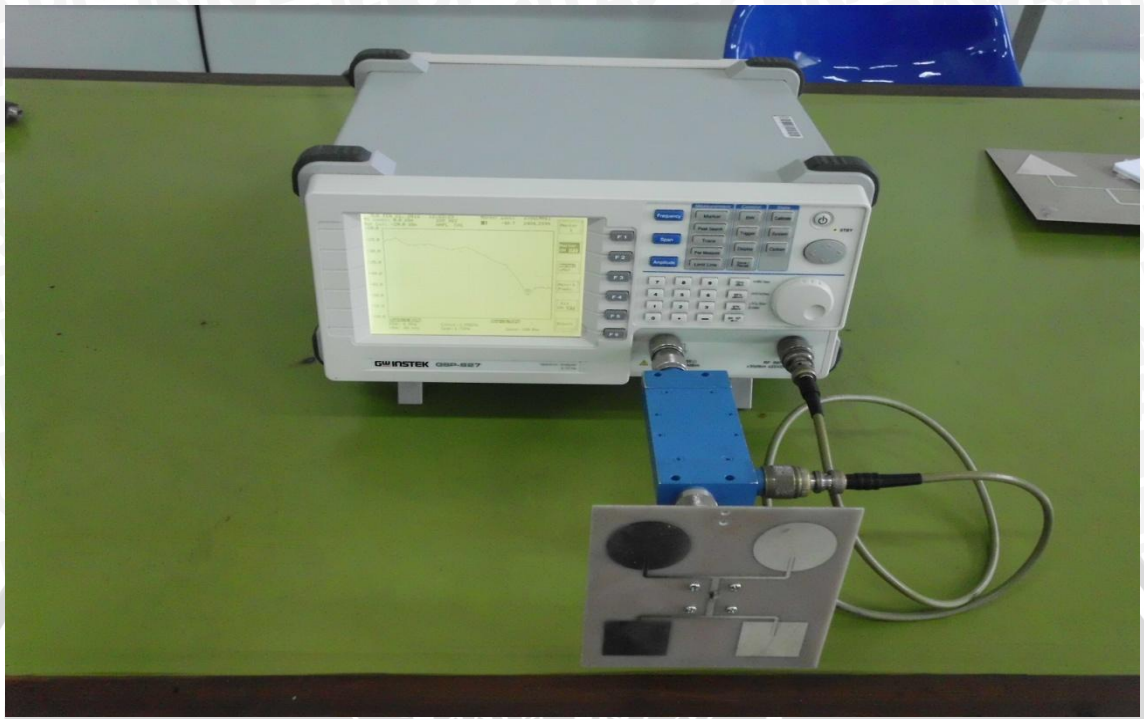
Gambar 4 Rangkaian Pengukuran Return Loss , Koefisien Pantul dan VSWR Antena Uji
