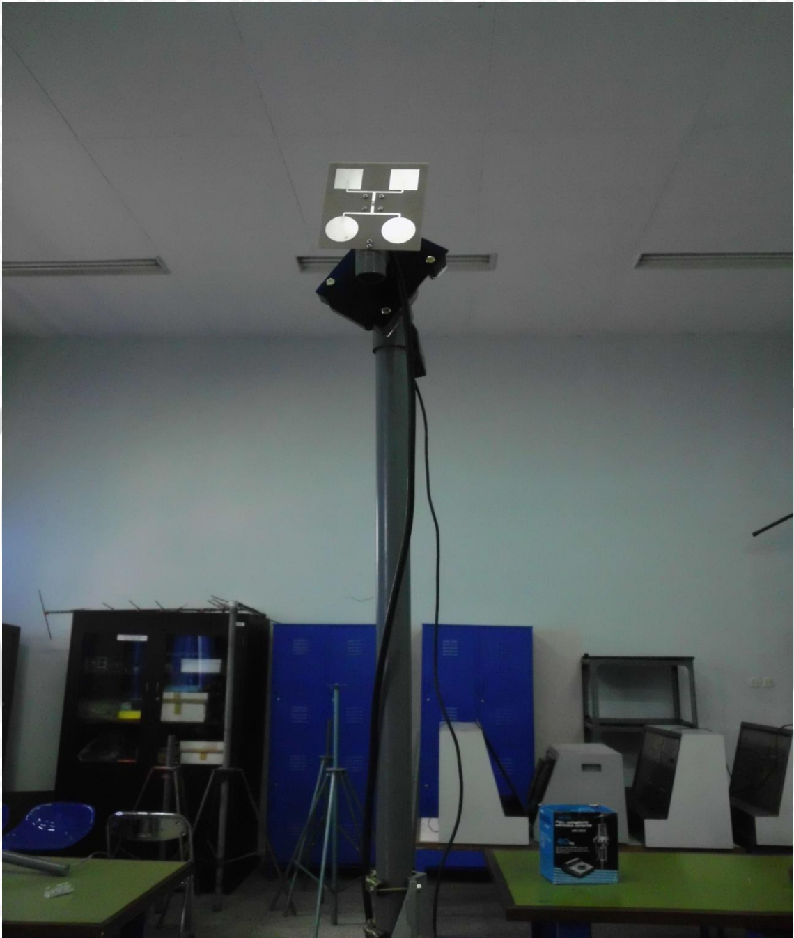
Gambar 9 Rangkaian Pengukuran Gain , Pola Radiasi dan Polarisasi Antena Uji
