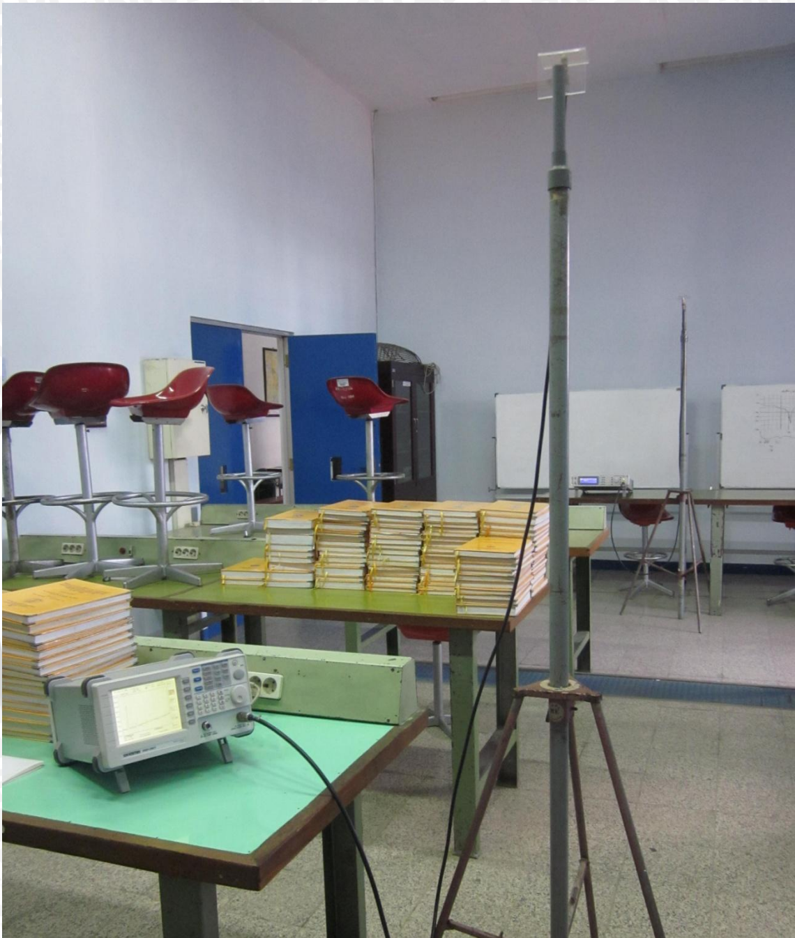
Gambar 8 Rangkaian Pengukuran Gain Antena Referensi
