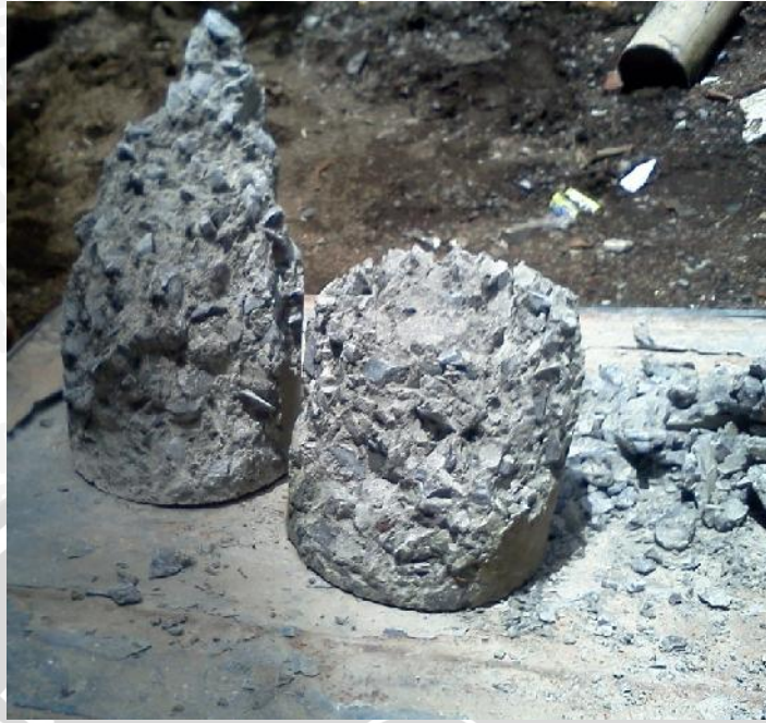
Gambar 4.7 Pemisahan agregat pada beton setelah dilakukan uji tekan
