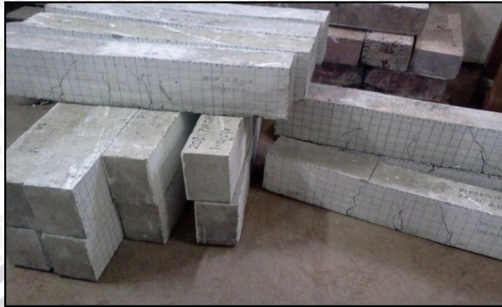
Gambar 4.18. Benda uji balok beton bertulang selesai diuji kuat lentur
