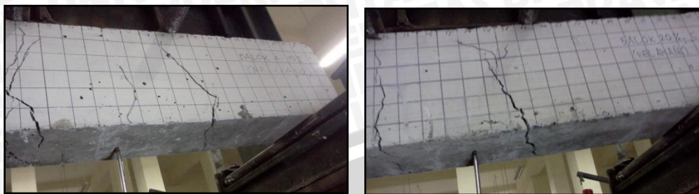
Gambar 4.15. Pola patahan balok beton bertulang
