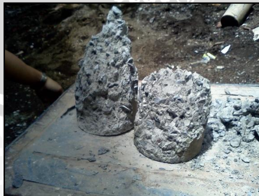
Gambar 4.10. Silinder beton setelah diuji kuat tekan
