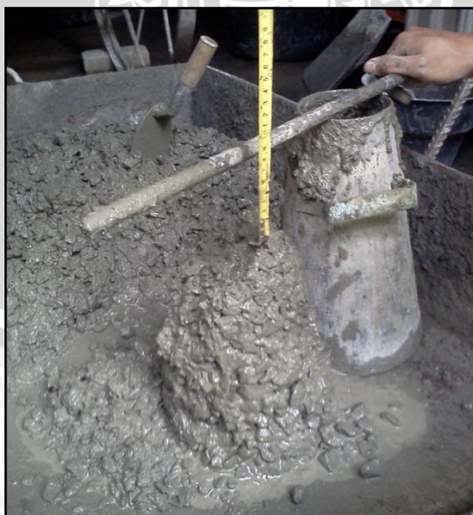
Gambar 4.7. Pengujian slump beton
