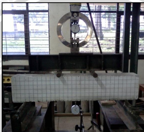
Gambar 4.14. Skema pengujian kuat lentur beton
