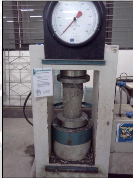
Gambar 4.9. Skema pengujian kuat tekan beton
