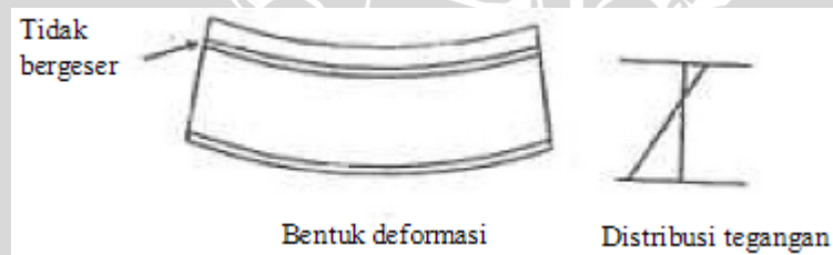
Gambar 2.5 Balok dengan aksi komposit penuh (Sumber: Setiawan, 2008)
