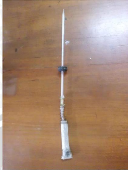
Gambar 3.4 Termometer Bola Basah
