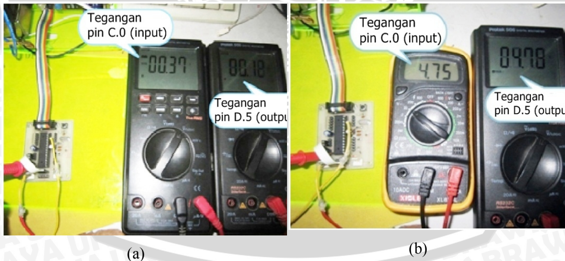
Gambar 5.9 Pengujian Rangkaian Mikrokontroler ATMega8
