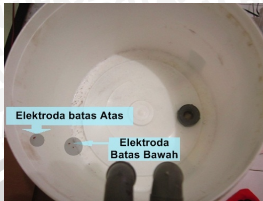
Gambar 5.7 Peletakan Sensor Level Air Tandon Tampak Atas
