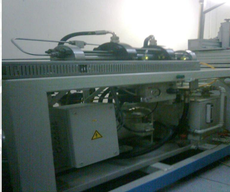
Gambar 3.2 Perangkat *intensifier pump*
