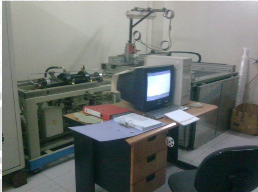
Gambar 3.1 Perangkat *water jet cutter machine*
