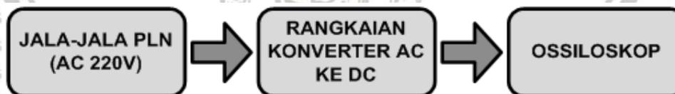
Gambar 5.1 Diagram Blok Pengujian Rangkaian Konverter AC ke DC
