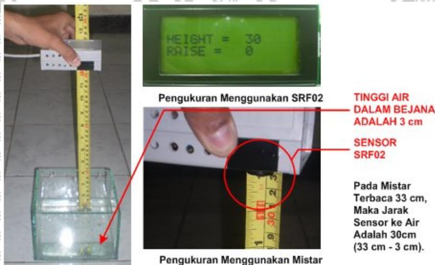
Gambar 5.12 Hasil Pengujian Sensor Ultrasonik SRF02
