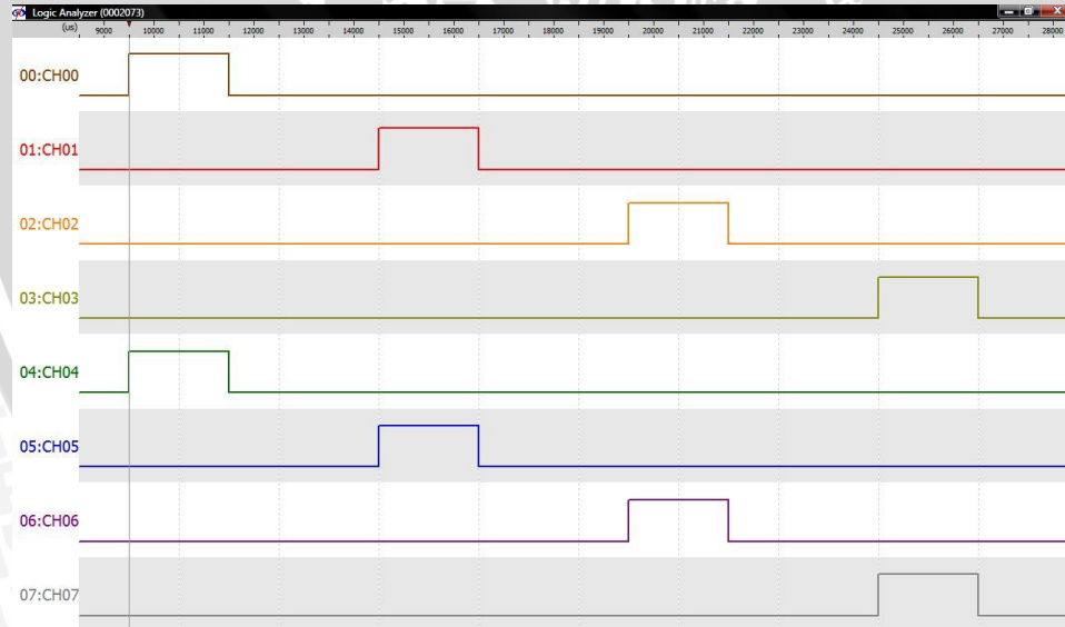
Gambar 5. 17. Sinyal Kontrol Multi Servo dengan lebar pulsa High 1500 \mu s
