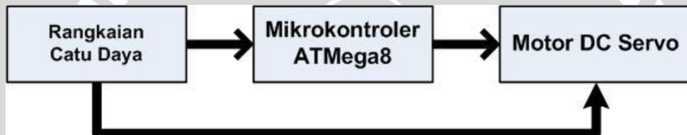
Gambar 5. 19. Diagram Blok Pengujian Motor DC Servo
