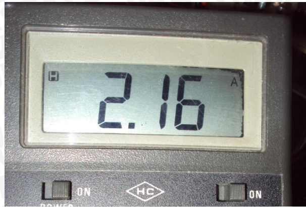
Gambar 5. 22. Besar Arus yang Dibutuhkan 8 Motor DC Servo
