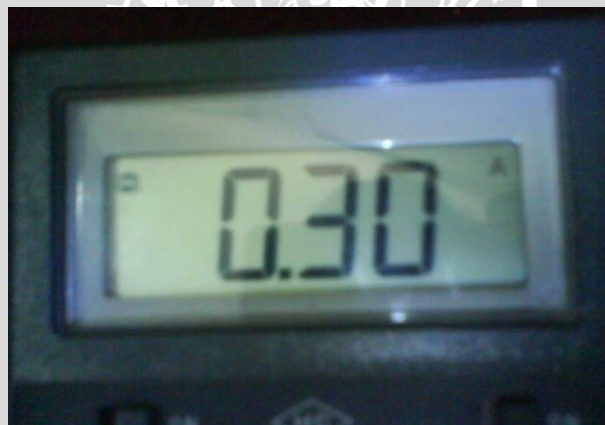
Gambar 5. 21. Besar Arus untuk Motor DC Servo Tunggal
