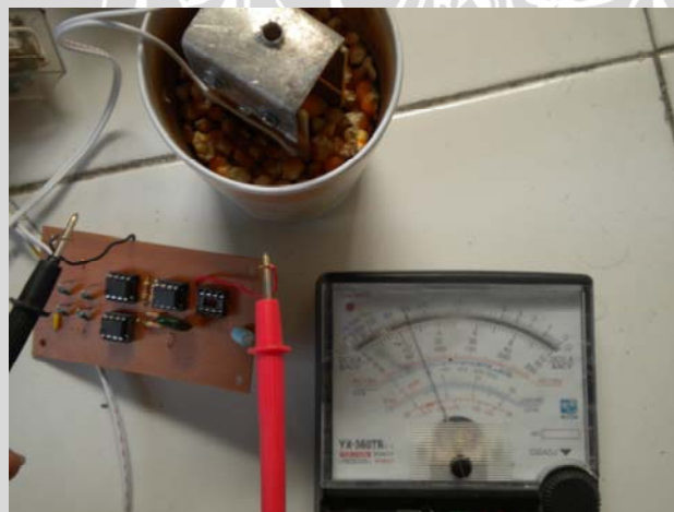
Gambar 5.7. Pengujian Sensor Kadar Air Dengan Kadar Air Jagung 14%
