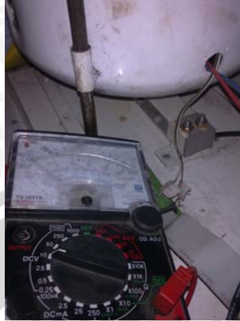
Gambar 5.10. Pengujian Sensor Berat Dengan Beban 1 kg
