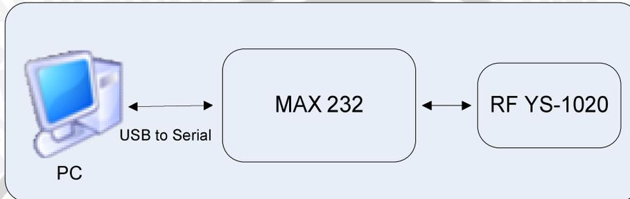
**Gambar 5.1** Diagram blok pengujian pengaturan *baudrate* dan *channel* modul RF
