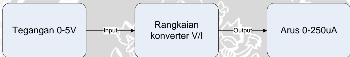
Gambar 5.2 Rangkaian konverter tegangan-arus ( V/I converter )
