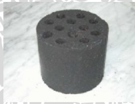
Gambar 2.4 Contoh briket biomassa di Eropa.
